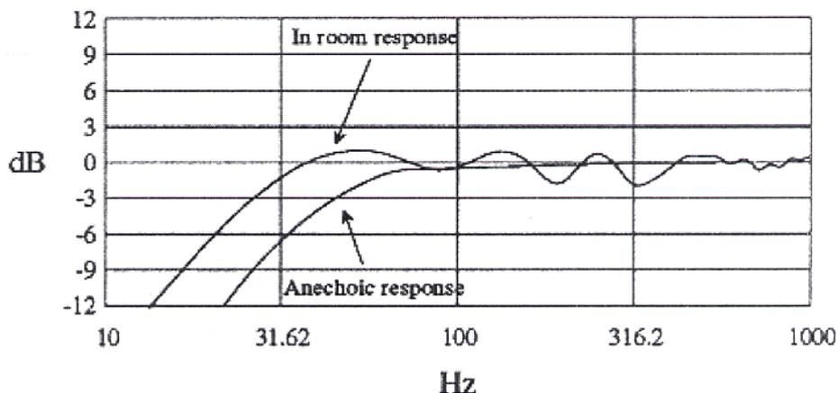
図 8.5 通常のリビングルームと無響室との違いを表します。スピーカーは後壁面から 1.4m、側壁面から 0.9m の位置におかれた場合の反応です。部屋の壁面からの補強によって低域反応が伸びている点に注目してください。
