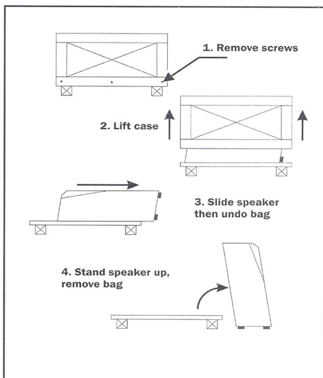
図3.1 スピーカーの取り出し方
