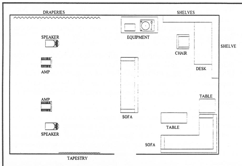
図8.9 リスニングルームの例。スピーカーの周りには一次反射を起こすようなものは置かれていません。側壁からの反射を吸収し、左右の対称性を保持すべくカーテンの反対側にタペストリーを掛けます。リスニング位置の背後に配置されたものは、定常波や共振を防ぐ役割を果たします。ふかふかのソファは低周波の定常波を防ぎ、じゅうたんは床からの一次反射を防ぎます。
