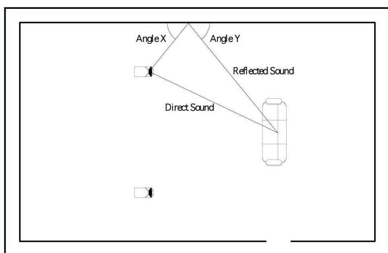
図7.2 音の平面への入射と反射の角度は同一である。例・角X=角Y 光線についても同じことがいえるので、一次反射を防ぐためにはどこに吸音材を付けるかを見分けるのに鏡を用いることができる。
