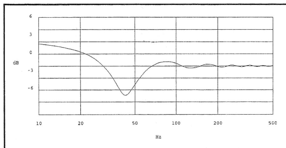
図 7.4 上の図と同じ、但しスピーカーは 2m 離れている。低域補強が前よりも低い周波で行われていることに注意。
