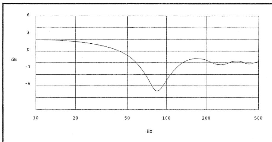
図 7.3 反射面からスピーカーを 1m はなしたときの周波の反響の変化（無響環境と比較して）
