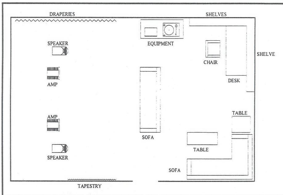
図 7.6 リスニングルームの例。スピーカーの周りには一次反射を起こすようなものは置かれていません。側壁からの反射を吸収し、左右の対称性を保持すべくカーテンの反対側にタペストリーを掛けます。リスニング位置の背後に配置されたものは、定常波や共振を防ぐ役割を果たします。ふかふかのソファーは低周波の定常波を防ぎ、じゅうたんは床からの一次反射を防ぎます。
