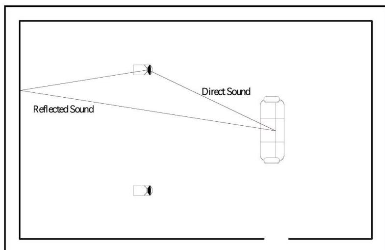
図7.1 スピーカーから直接放射された音より壁に反射した音の方が遅くリスナーに到達しなければならない。
