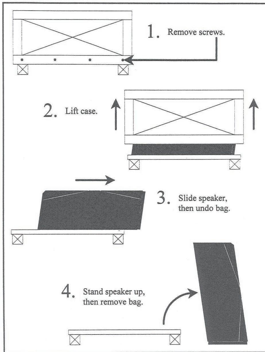
図2.1 スピーカーの取り出し方
