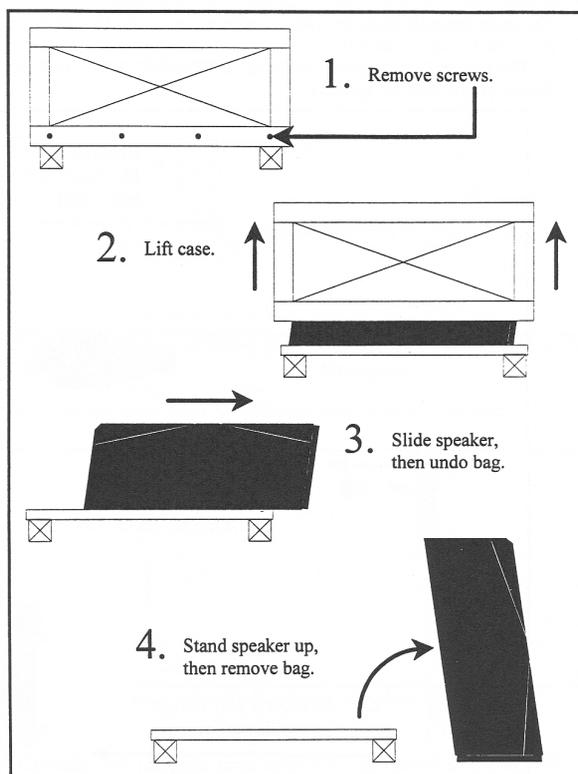
図 3.1 スピーカーの取り出し方
