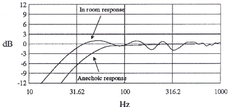
図8.5 通常のリスニングルームと無響室との違いを表します。スピーカーは後壁面から1.4m、側壁面から0.9mの位置におかれた場合の反応です。部屋の壁面からの補強によって低域反応が伸びている点に注目してください。
