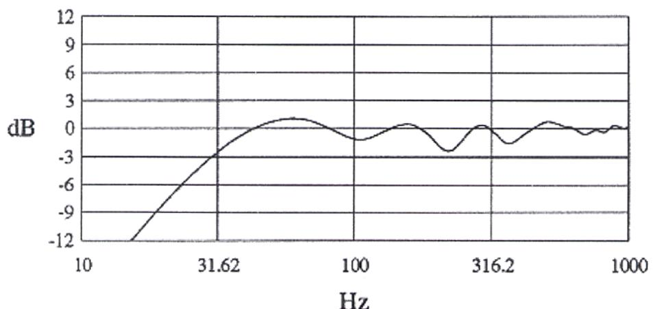
図 8.7 リスニングルームでの反応。スピーカーの位置は側壁より 70cm、後壁より 1.2m。
