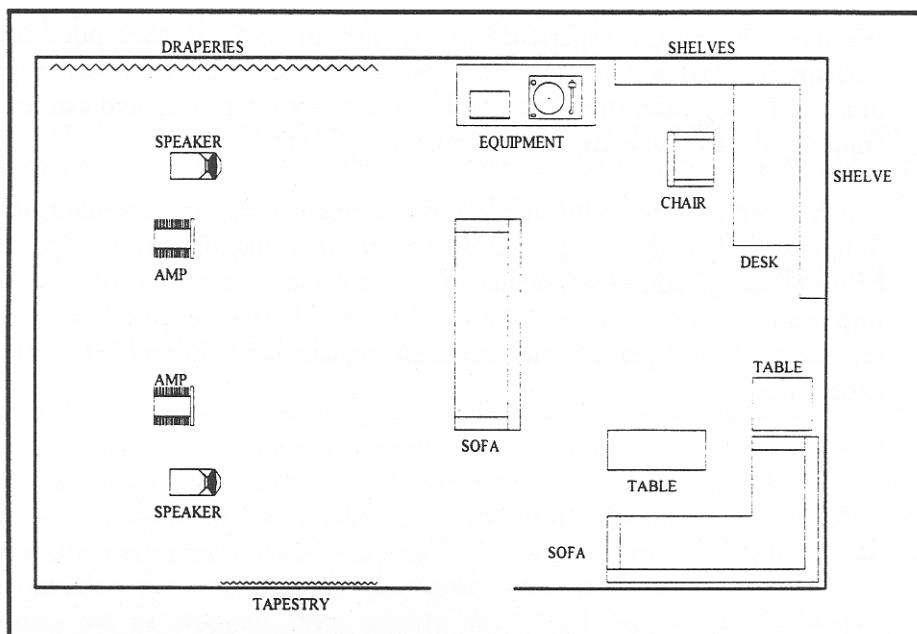
図 8.9 リスニングルームの例。スピーカーの周りには一次反射を起こすようなものは置かれていません。側壁からの反射を吸収し、左右の対称性を保持すべくカーテンの反対側にタペストリーを掛けます。リスニング位置の背後に配置されたものは、定常波や共振を防ぐ役割を果たします。ふかふかのソファーは低周波の定常波を防ぎ、じゅうたんは床からの一次反射を防ぎます。
