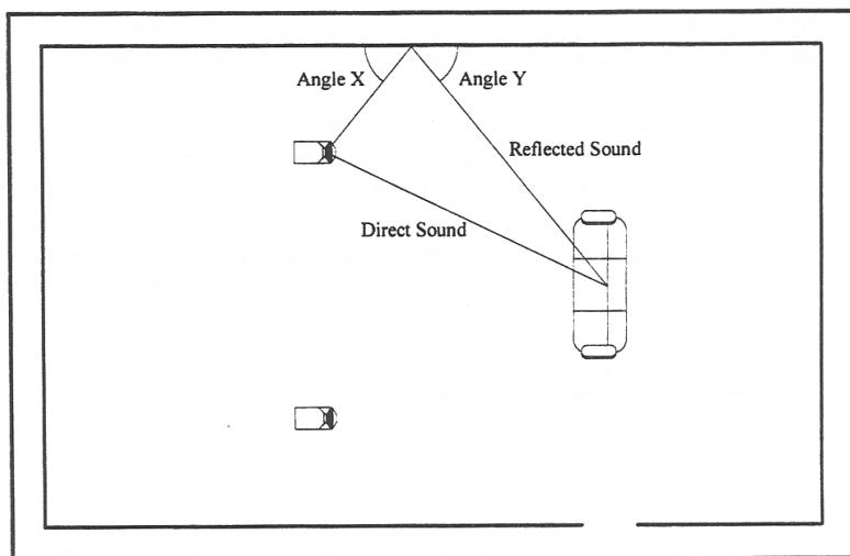
図8.2 音の平面への入射と反射の角度は同一である。例・角X=角Y 光線についても同じことがいえるので、一次反射を防ぐためにはどこに吸音材を付けるかを見分けるのに鏡を用いることができる。
