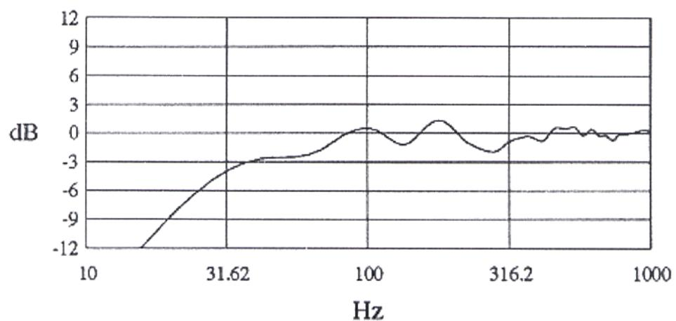
図 8.8 リスニングルームでの反応。スピーカーの位置は側壁より 1.1m、後壁より 2m。
