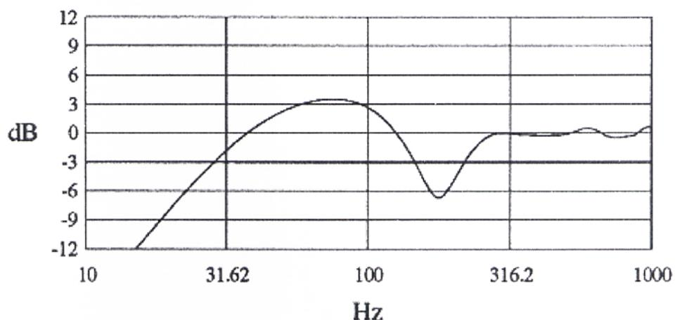
図 8.6 好ましくない設置によって得られた不均一な周波数反応。この場合は後壁面、側壁面からそれぞれ 60cm の位置に設置。
