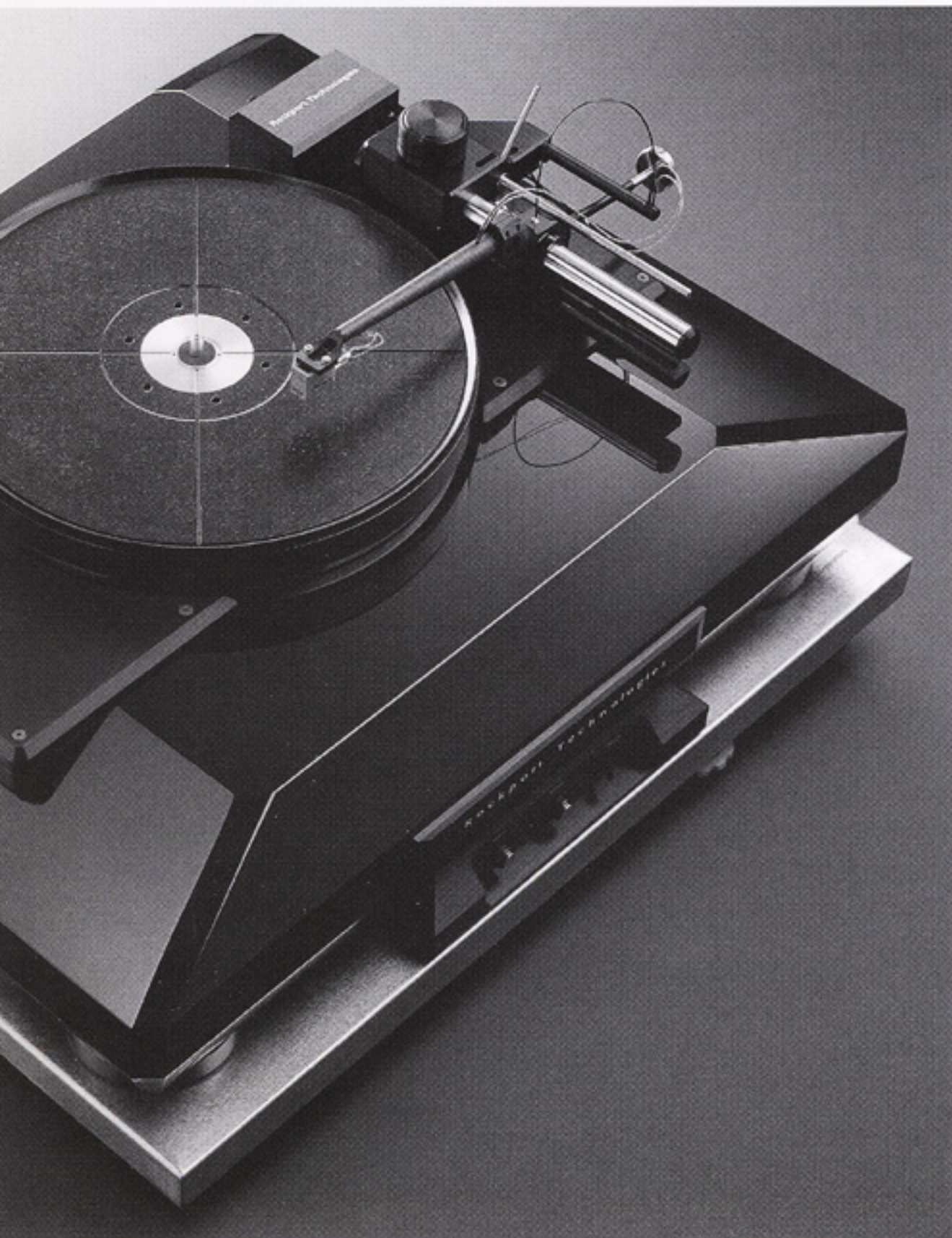
◆トーンアーム=スタティックバランス型リニアトラッキングアーム◆フォノモーター駆動方式=ベルトドライブ◆回転数=33-1/3、45rpm◆ターンテーブルプラッター=30.5cm径、アルミニウム・粘弾材・アクリル3層構造◆寸法/重量=W610×H178×D508mm/56.7kg◆コンプレッサー部必要電力=約50w・100vAC専用エアホース15m付属
