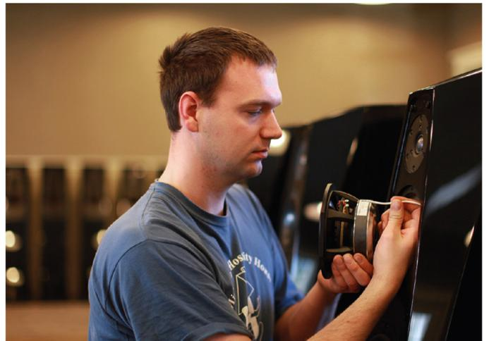
ドライバーは一本一本特性が微妙に異なり、それに合わせてネットワークが調整される。ネットワークと完全にマッチしたミッドレンジドライバーをマウントする。
