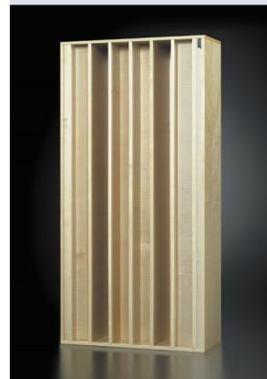
QRDの代表的なスタンダード拡散パネルです。全てのリスニングルームに優れた効果を発揮します。どの角度から入射した音もピークとディップを生じさせず、均一に拡散、周波数帯域は250Hzから8kHzまで対応いたします。また、吸音(ディッド)は一切行わないでエネルギーは殺さずライブに保つことも可能です。スピーカー背後(正面の壁)に設置して使用することにより、理想的にステレオイメージを再現することが可能です。また、後壁面に設置することで心地良いホールの響きと、はっきりとしたサウンドステージを創り上げることが可能です。
