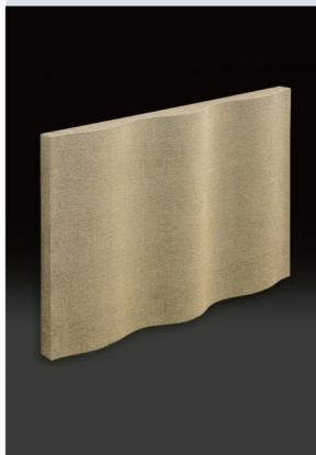
ハイブリッドパネル、BADの表面にウェイブ処理することで、入射角にも左右されない均等な拡散・吸音効果を得ることができます。独自のウェイブによって拡散係数は500Hz以上においてほぼ一定です。音楽スタジオ、美術館などで使用されているギルフォード・メイン社製ファブリックを使用。側壁、天井面の拡散材として幅広く使用できます。取付は、BAD同様に専用金具で容易に行えます。
