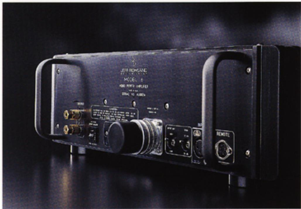
した。純フラットなレスポンスを200kHzまで1%以下の誤差、RCフィルター不要のピュア抵抗値、20kHzにて60dB以上のコモンモードリジェクションを得、全帯域に渡りグループディレイが一定、さらに12dB／オクターブペッセルフィルターアラインメント、20Hzで0.01%以下の超低歪0-1kΩのソースインピーダンスに対して全く問題なく対応するという性能を持っています。
