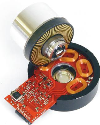
プラッターは試聴を繰り返した上で最適な重量のアルミ、銅、マグネシウムの特殊合金製とし、レコードとの接触面にはダンピング効果を考慮してクリスタルガラスを採用。また、クランパーとそれに適したプラッター面の僅かな傾斜によってレコードはプラッターと一体化します。プラッターは事実上モーターと直結していますので、ノイズ源となる接觸点はありません。また、ベルトの張力や変形などの心配もなく、その点でもDDモーターは有利です。
